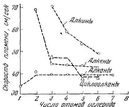
Рис. 3. Зависимость нормальной скорости пламени углеводородов в воздухе от числа атомов углерода в молекуле
