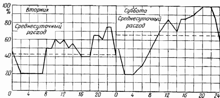
Рис. 2-5. Суточный график горячего водоснабжения жилого района.
