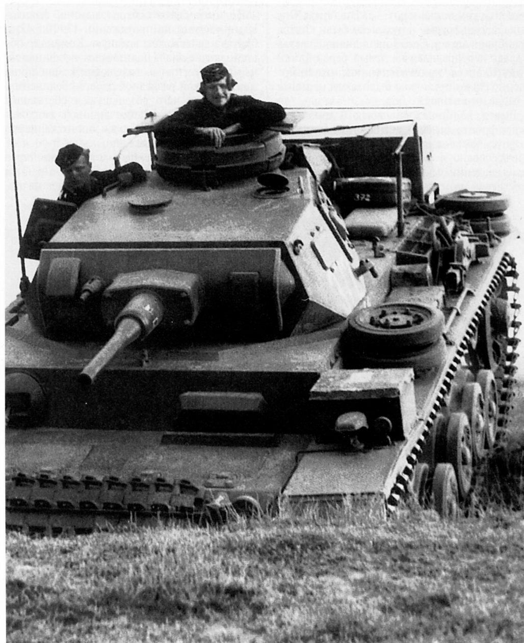
Командирский танк Pz.Kfz. III преодолевает ров. Группа армий «Юг», май 1942 года. На башне различим номер «372», нанесенный белой краской, на корме корпуса хорошо видна рамочная антенна (АСКМ).
