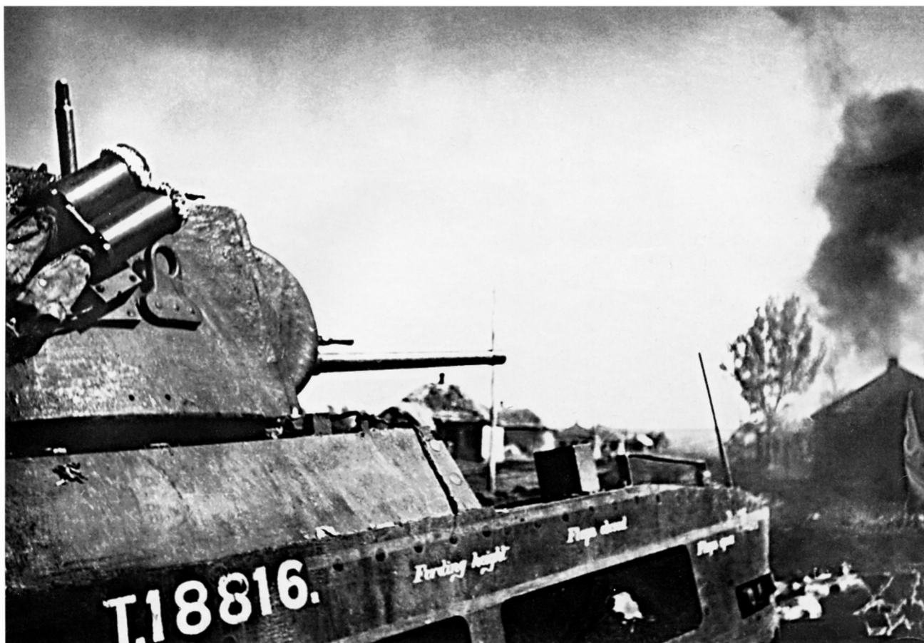
Английский танк МК-II «Матильда» перед атакой. Юго-Западный фронт, май 1942 года. На борту виден заводской номер машины T18816, а также надпись показывающую максимальную глубину брода при преодолении водных преград. Возможно, машина из состава 38 или 37-й танковой бригады (АСКМ).
